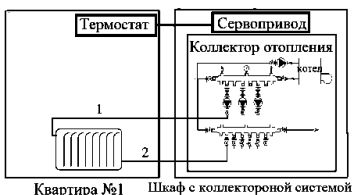
Рис.1. Структурная схема подключения коллекторной системы к радиаторам отопления. 1- горячая вода, 2 –охлажденная вода.
